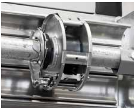
ZABEZPEČENIE v prípade prasknutia pružín
